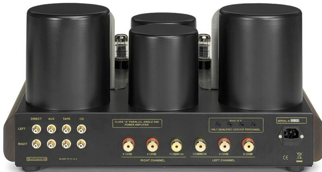
Von außen zugänglich: die Bias-Regelungen für die Leistungsröhren (oben rechts)
