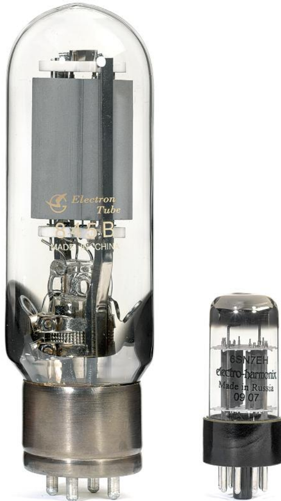
Soll in einer extrem schnellen Kathodenfolger-Schaltung stecken: 6SN7 Treiber (rechts) für die 845er Endröhre
