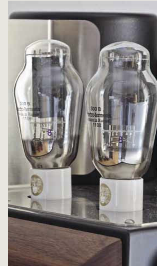
Die Electro-Harmonix-Endröhren kommen in der nobleren „Gold“-Variante zum Einsatz. Der Keramiksockel ist Standard
