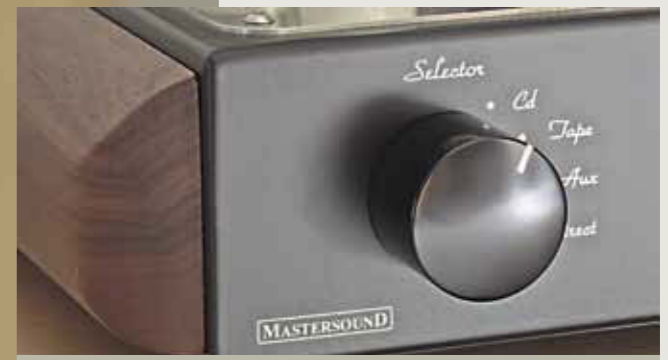
Die vierte Position des Quellenwahlschalters wählt den Vorstufeneingang – die italienische Interpretation von „Direct“
