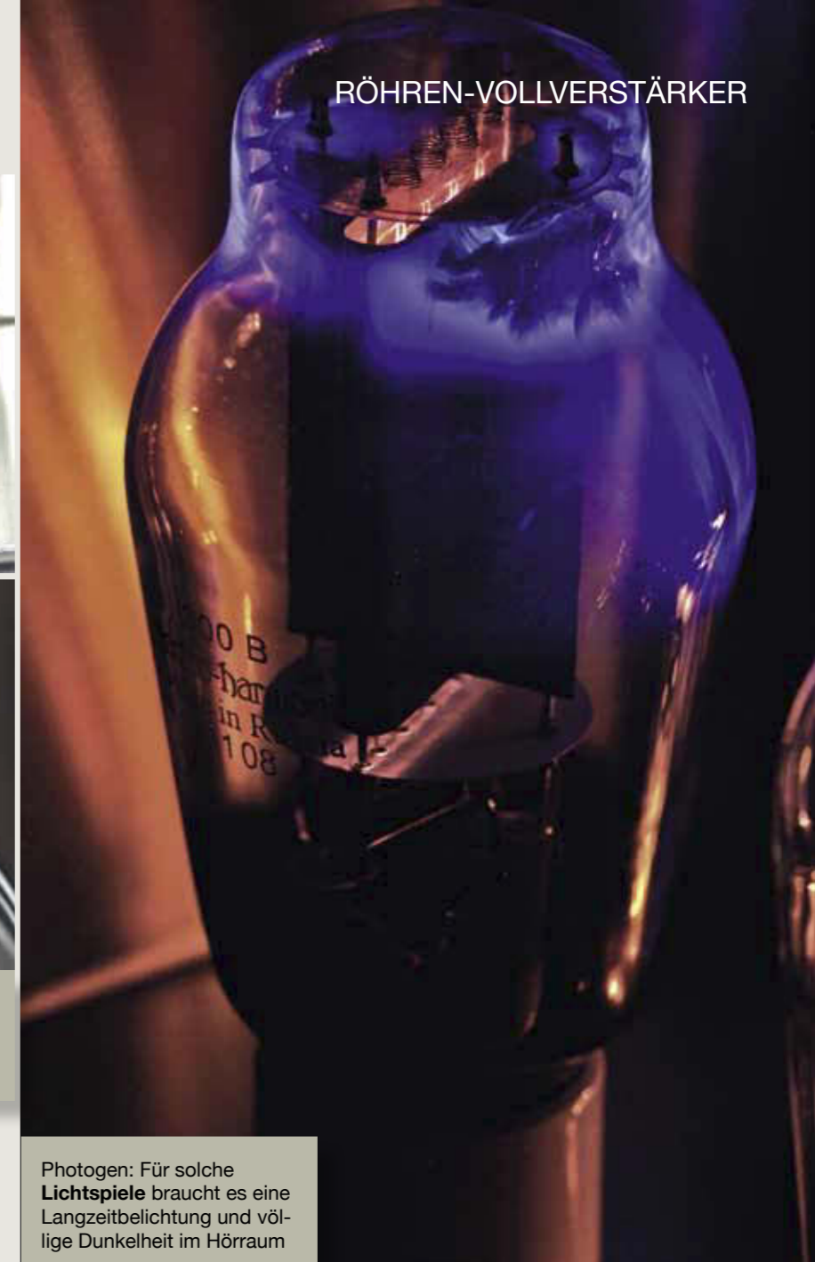
Die Heizfaden-Aufhängung der EH-300B ist anders gebaut als bei den WE-Abkömmlingen
