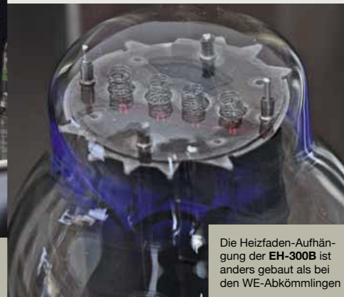
Die Electro-Harmonix-Endröhren kommen in der nobleren „Gold“-Variante zum Einsatz. Der Keramiksockel ist Standard
